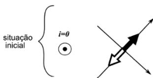
Ao ligar o gerador, a corrente sobre o fio (saindo do plano da ilustração). Assim, a orientação da bússola passará a ser a seguinte:
