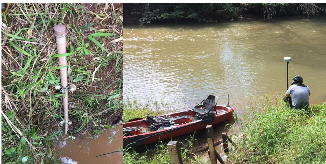
Figura 1: a) Linígrafo instalado na margem do Rio Meia Ponte; b) Coleta dos dados de localização geográfica e de cota da lâmina água.
