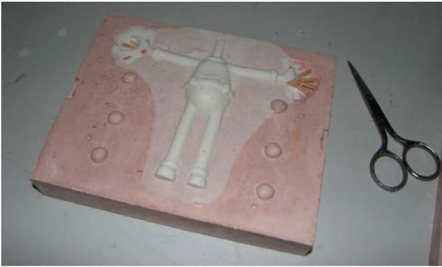
Figura 9 - Boneco de silicone sendo retirado do molde
