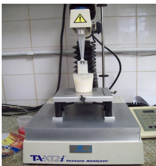
Figura 11. Análise de textura “firmeza” do mingau de farinha láctea em texturômetro TA-XT2i.
