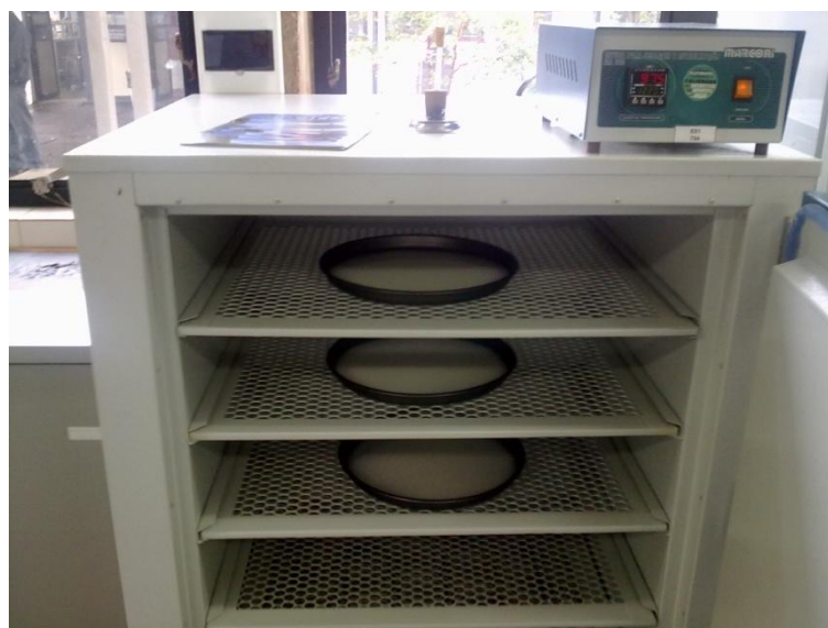
Figura 9. Secagem da farinha de grãos quebrados de arroz hidrolisados com \alpha -amilase e amiloglucosidase em estufa de esterilização.
