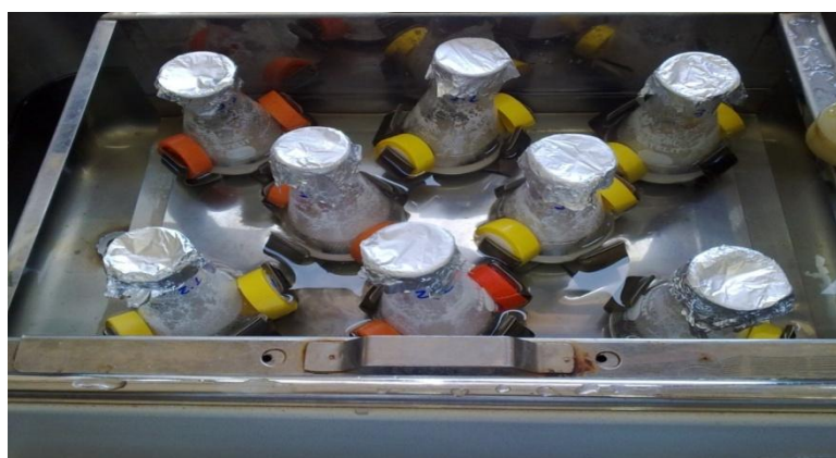
Figura 8. Hidrólise enzimática com \alpha -amilase e amiloglicosidase da farinha de grãosquebrados de arroz em banho-maria sob agitação horizontal em temperatura de 40^\circ\text{C} .
