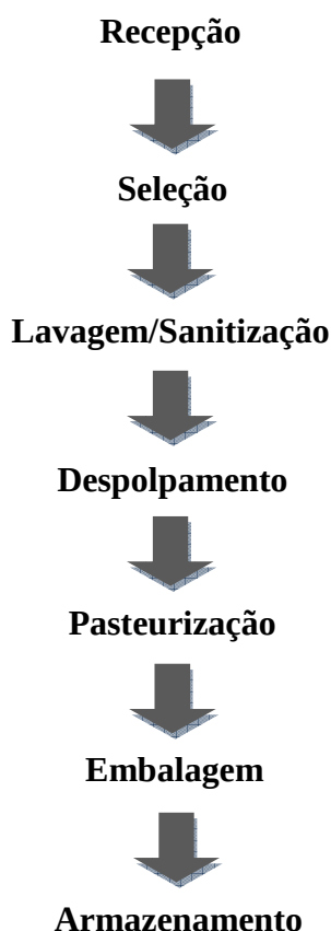
Figura 1: Fluxograma do processamento de polpa congelada de jabuticaba
