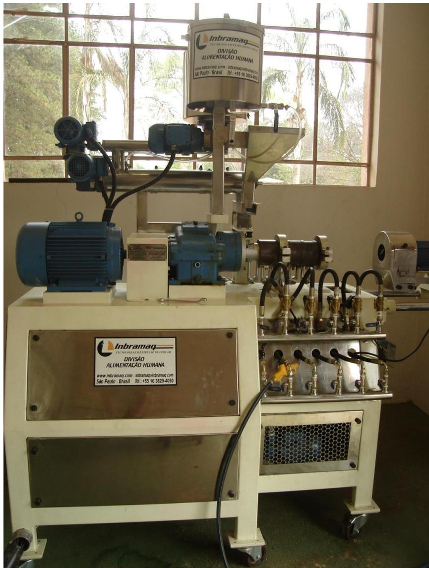
**Figura 6.** Extrusora (Imbramaq, PQ30, Ribeirão Preto, Brasil) utilizada para produção da farinha pré-gelatinizada de arroz.
