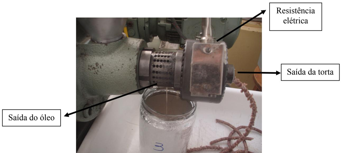
**Figura 2:** Extração de óleo em prensa mecânica
