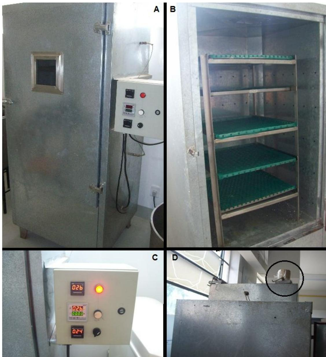
**Figura 4.** Secadora utilizada durante ensaio de secagem da polpa residual de batata. Vista externa (A); vista interna com as bandejas (B); caixa de controle da temperatura e velocidade do ar (C); vista lateral com detalhe do orifício de saída do ar (D).
