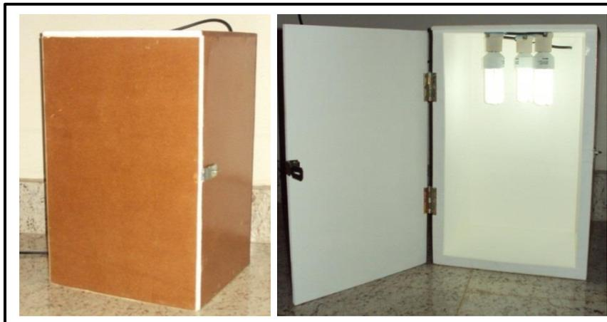
Figura 3 - Caixa preta construída em madeira tipo MDF para o estudo de estabilidade frente a estresse foto oxidativo do óleo de pequi
