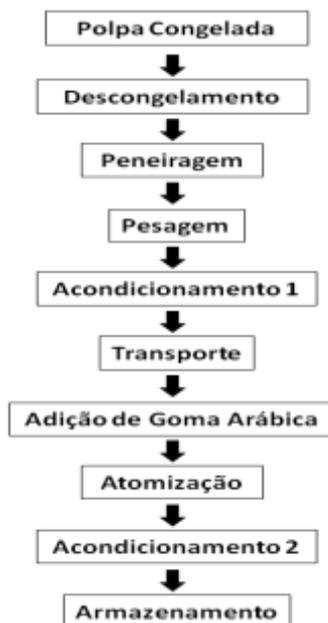
**Figura 7.** Etapas do processamento de polpa de cagaita atomizada.
