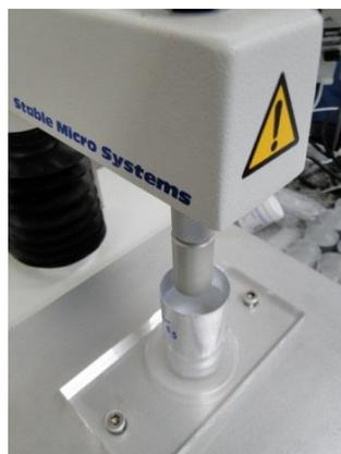
**Figura 20.** Probe de aço inoxidável cilíndrica de 20 mm de diâmetro (P/20) utilizada para perfuração das amostras na análise de textura.
