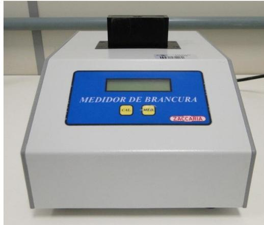
**Figura 21.** Medidor de brancura, transparência e grau de polimento do arroz.
