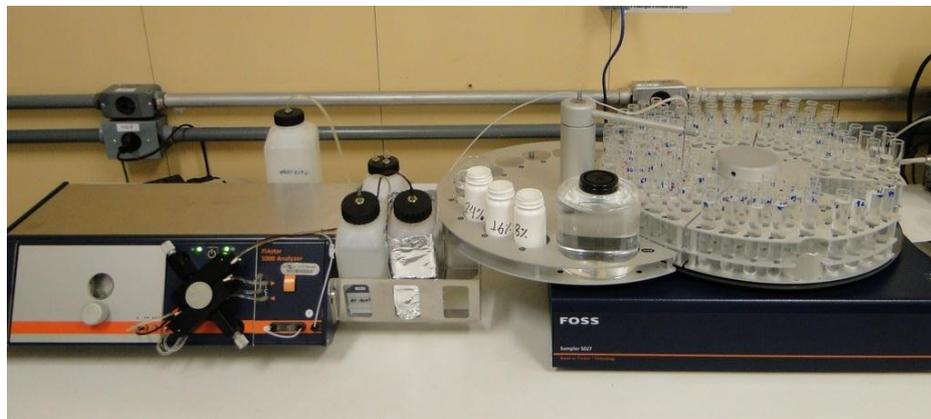
**Figura 12.** Equipamento por injeção de fluxo, FIAstar 5000, da marca FOSS utilizado para a determinação do teor de amilose.
