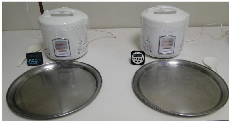
**Figura 16.** Teste de cocção de amostras de arroz em panelas elétricas Mondial, modelo Bianca Rice 4.
