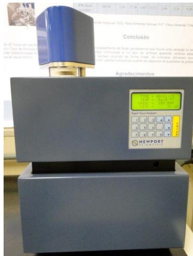
**Figura 13.** Rapid Visco Analyser (RVA) da Newport Scientific, indicando tempo de análise (s), temperatura (°C), velocidade (rpm) e viscosidade (cP).
