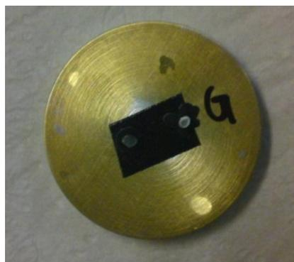
**Figura 9.** Suporte porta-amostras (*stub*) com as seções transversais dos grãos gessado e translúcido aderidos à fita de carbono.
