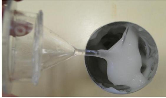
**Figura 14.** Pasta de arroz após a análise do perfil viscoamilográfico no RVA.
