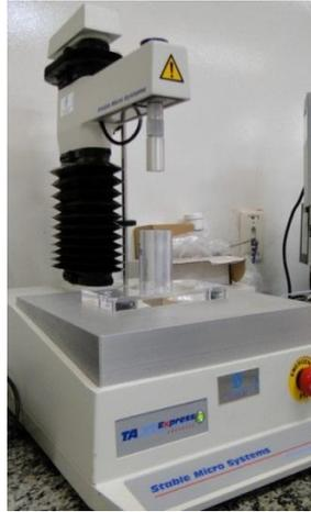
**Figura 19.** Texturômetro TA.XT *Express Enhanced* utilizado na análise de textura instrumental.
