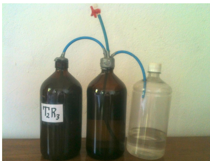
Figura 3. Conjunto de frascos e tubos que constituíram o reator.
