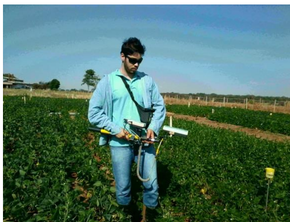
Figura 12. Leitura dos índices de reflectância dos cultivares de feijão com o sensor radiométrico Crop Circle
