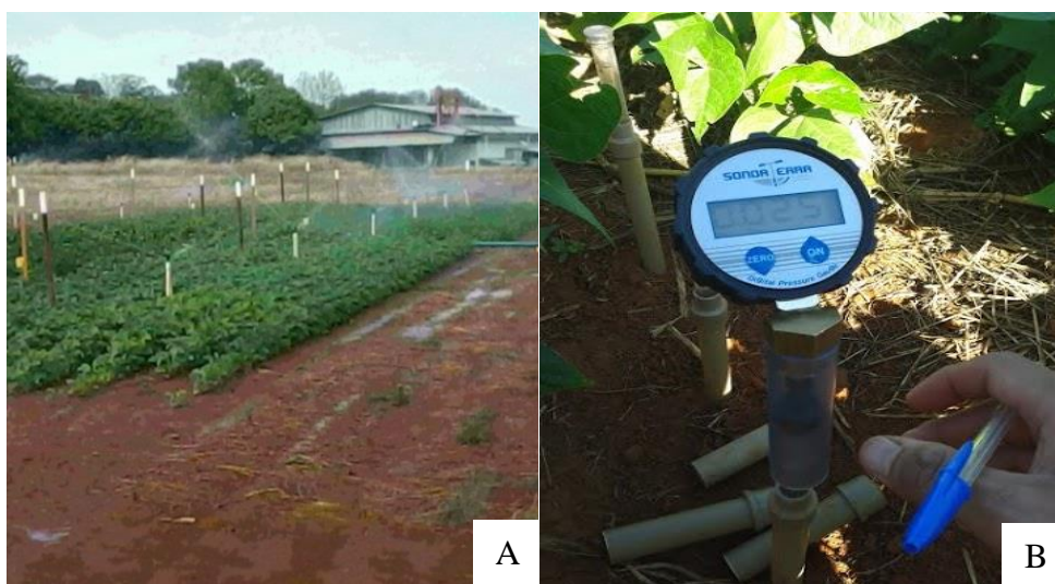
Figura 10. A) Irrigação por aspersão, B) com manejo da umidade do solo realizado por tensiômetros
