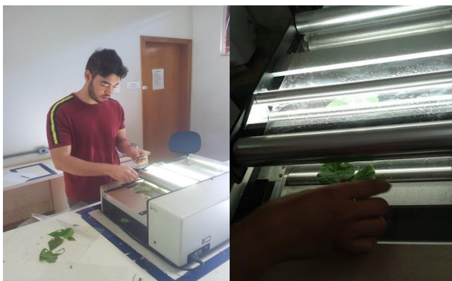
Figura 11. Determinação da área foliar com o integrador de área foliar fotoelétrico LI-COR, modelo LI-3100 C
