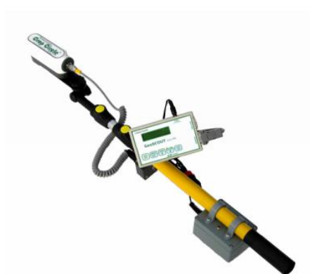
Figura 14. Sensor de luz Crop Circle ACS-430 utilizado para a medição do NDVI do feijoeiro, em Santo Antônio de Goiás-GO
