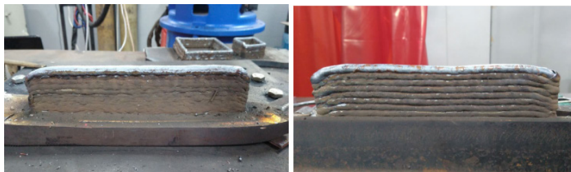
Figura 5 - Configuração 2: Temperatura de interpasse 150°C a) sem alimentação de arame frio b) com alimentação de arame frio
