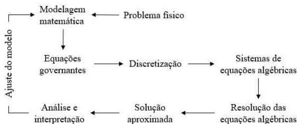
Figura 2 – Etapas para a obtenção da solução numérica de um problema de fluidos
