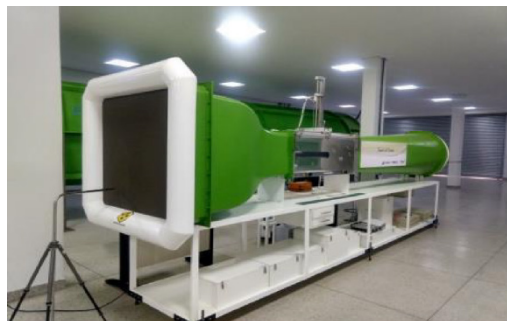
Figura 2 - Túnel de vento circuito aberto AeroAlcool
