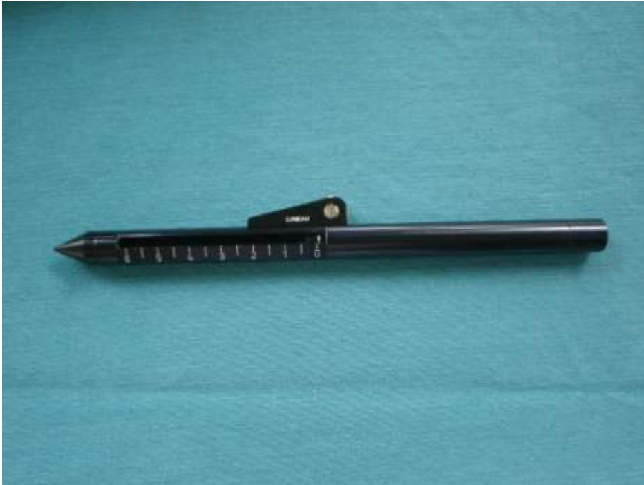
FIGURA 1 – Estesiômetro de Cochet-Bonnet, náilon 0,12 mm de diâmetro, Luneau, Paris, França. Belo Horizonte, 2008.
