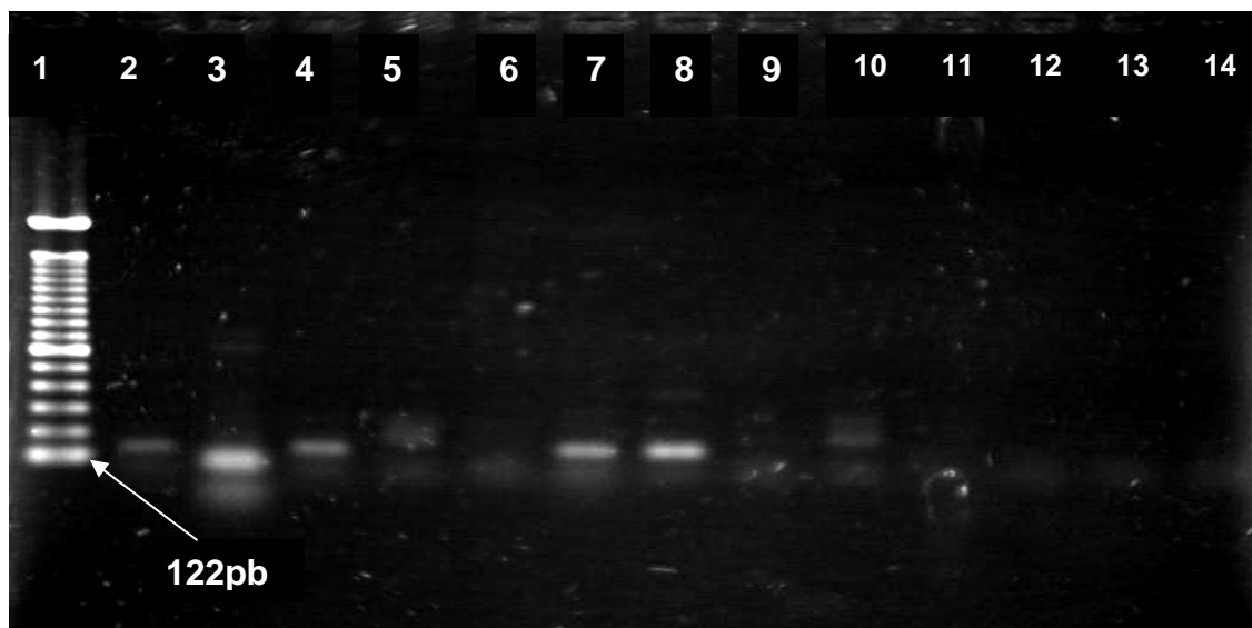
FIGURA 2. Eletroforese em gel de agarose a 1,0%. Na canaleta 1 está o padrão de peso molecular (DNA ladder 100pb). Na canaleta 2 está o controle positivo de Salmonella ( Salmonella Typhimurium isolada de carcaça de frango). Canaleta 3 está outro controle positivo ( Salmonella Enteritidis isolada de carcaça de frango). Nas canaletas 5 e 14 encontram-se os controles negativos, nas canaletas (4, 6, 7, 8 e 9) encontram-se amostras positivas e nas demais canaletas (10, 11, 12 e 13) encontram-se amostras negativas.
