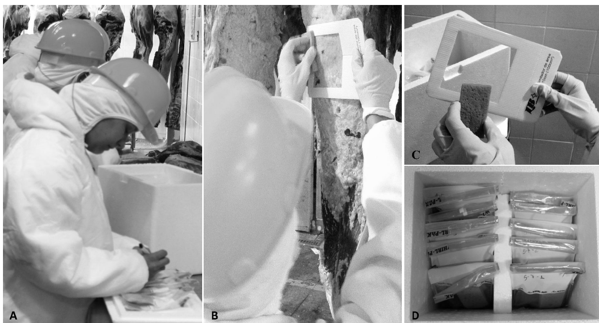
FIGURA 09 - Esfregaço do quarto traseiro com esponja para análise bacteriológica. (A) Identificação das esponjas. (B) Esfregaço com esponja estéril umedecida na região do lombo. (C) Luva estéril, esponja abrasiva umedecida e molde descartável para delineamento da área (100cm 2 ). (D) Amostras acondicionadas em caixa isotérmica.
