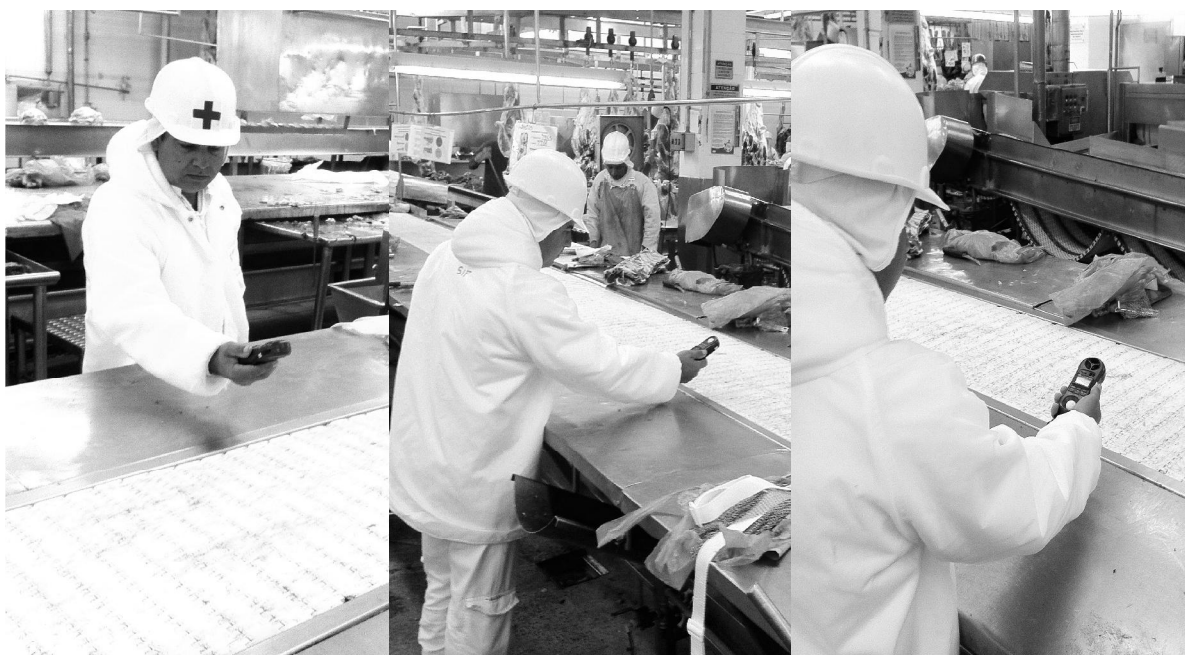
FIGURA 02 – Leitura da temperatura da sala de desossa com termômetro-hidro-anemômetro, modelo VA8021 da marca Akso. Fonte: Acervo pessoal (2014).
