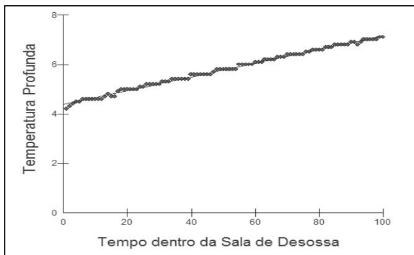
Figura 17 - Curva de temperatura profunda da picanha em sala de desossa climatizada a 12°C. A função linear que descreve esta relação é: TPf = 4,38 + 0,03 \times t Onde “TPf” é a temperatura profunda final do contrafilé e “t” é o tempo de permanência dentro da sala de desossa. O coeficiente de determinação (R 2 ) foi 99,47%.
