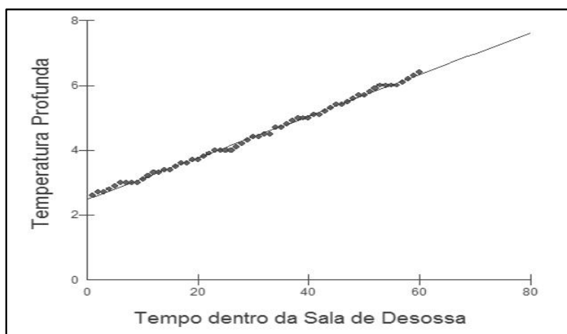
Figura 18 - Curva de temperatura profunda da picanha em sala de desossa climatizada a 15°C. A função linear que descreve esta relação é: TPf = 2,49 + 0,06 \times t . Onde “TPf” é a temperatura profunda final do contrafilé e “t” é o tempo de permanência dentro da sala de desossa. O coeficiente de determinação (R 2 ) foi 99,73%.
