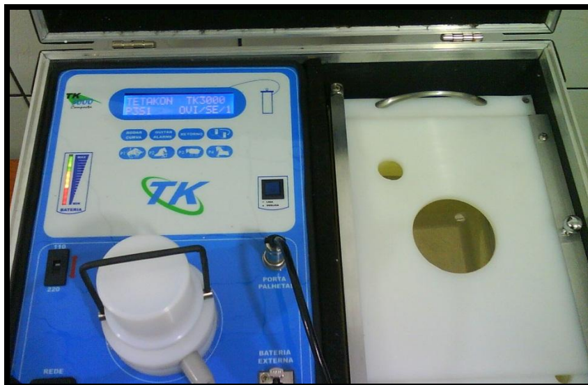
FIGURA 4 – Máquina de congelação de sêmen (Tetakon ® - TK 3000) programada para congelamento de sêmen ovino.
