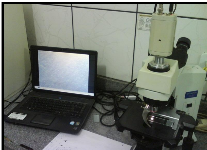
FIGURA 2 – Microscópio óptico com contraste de fase (BX41TF, Olympus, Japão), com filmadora ligado em sistema de captura de vídeo e imagem utilizado para análise seminal.
