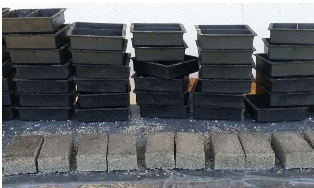
Figura 3.4 – Tijolos de concreto apos a desmoldagem.
