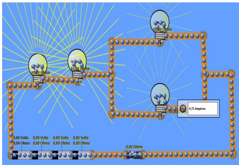
Figura 35 - Corrente elétrica na lâmpada 4 da associação em paralelo.
