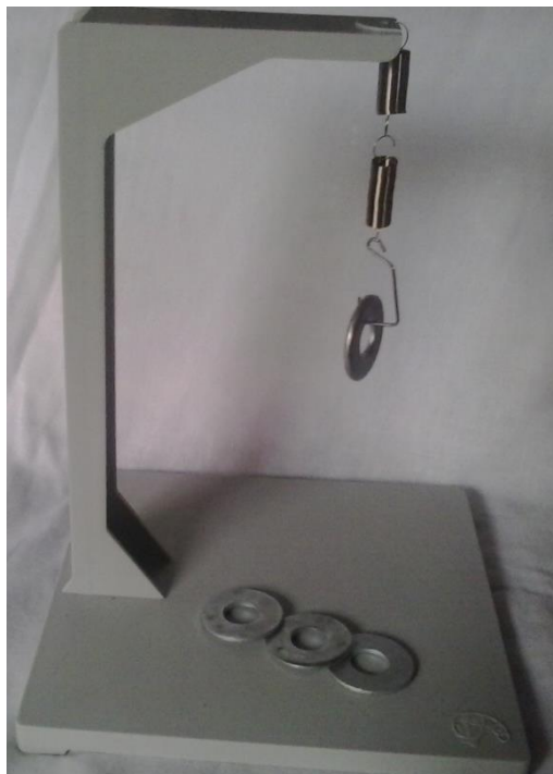
Figura 10 – Transformação de energia potencial gravitacional em elástica. Fonte: Elaborada pelo autor.
