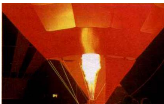
Figura 1 – O balão sobe na atmosfera porque o ar tem sua densidade reduzida ao ser aquecido. [3]
