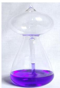
**Figura 19** – Ebulidor de Franklin: ao variar a temperatura ocorre um aumento de pressão deslocando do líquido para cima. Fonte: Elaborada pelo autor.
