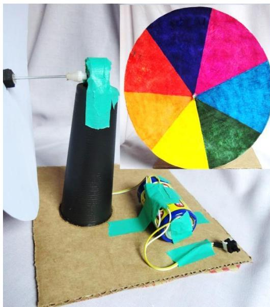
**Figura 12** – Experimento Disco de Newton. Fonte: Elaborada pelo autor.
