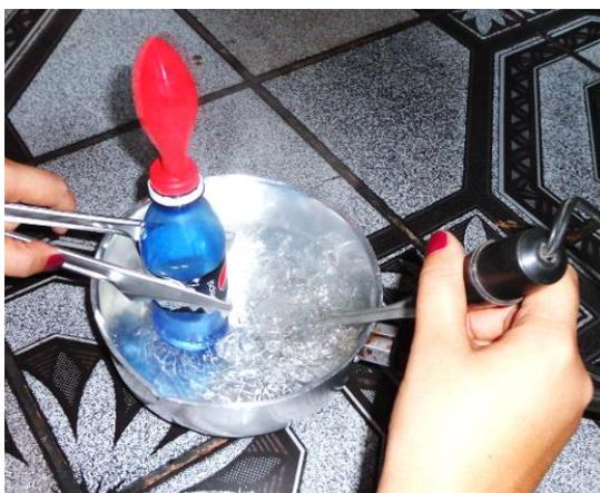
**Figura 9** – Aumentando a temperatura de um gás ocorre uma dilatação gasosa. Fonte: Elaborada pelo autor.
