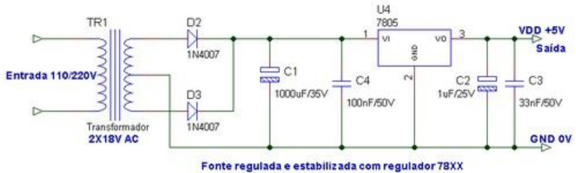
Figura A-16 (c) – Circuito fonte AC/DC estabilizada com regulador de tensão.
