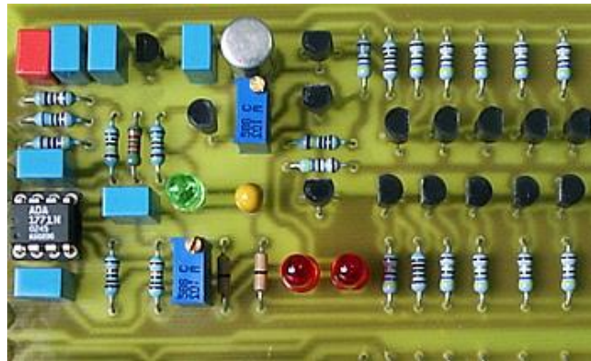
Figura A-2 - Vista parcial da placa de circuito impresso (PCB) de um circuito de áudio que utiliza componentes para montagem por inserção (through hole).
