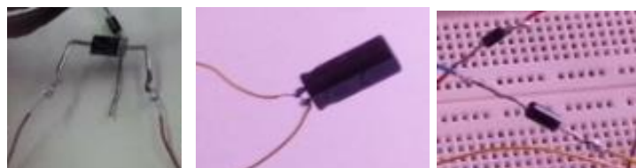
Figura 2.23 – Componentes com um pequeno fio soldado em seus terminais.
