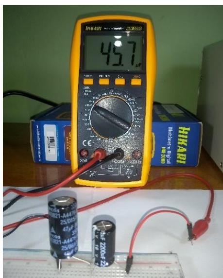
Figura 5.3 – Medição da capacitância equivalente da associação em série de dois capacitores. Fonte: o autor (2019)
