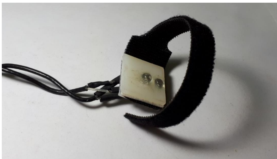
Figura 5.10 – Aparato de suporte desenvolvido para apoio do dedo no processo de medição. Fonte: o próprio autor (2019)
