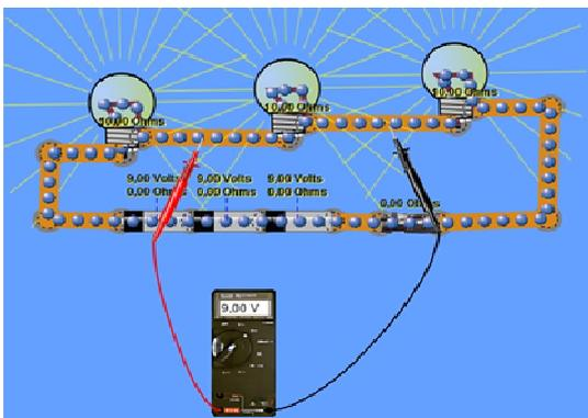
Figura 6 . Tensão elétrica na lâmpada 2.
