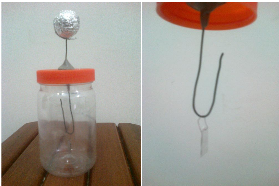
Figura 15 – Foto do eletroscópio de folhas construído por um dos grupos, feito com materiais de baixo custo.
