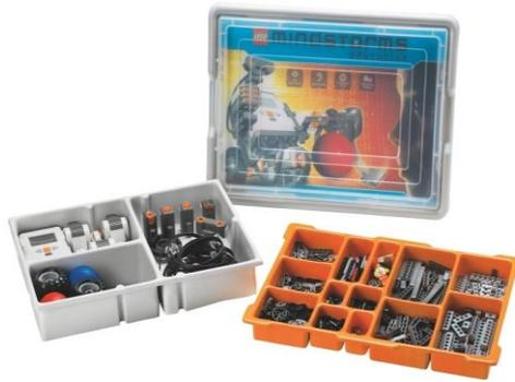
Figura 1: Foto das bandejas e das peças do Kit 9797do NXT.
