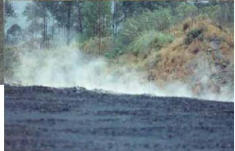
Arredores de Siderópolis, a piritas das pilhas de rejeito em combustão espontânea, produzindo  $\text{SO}_2$  e sulfetos orgânicos. Parte do gás se transforma em  $\text{H}_2\text{SO}_4$ , devido à umidade.
