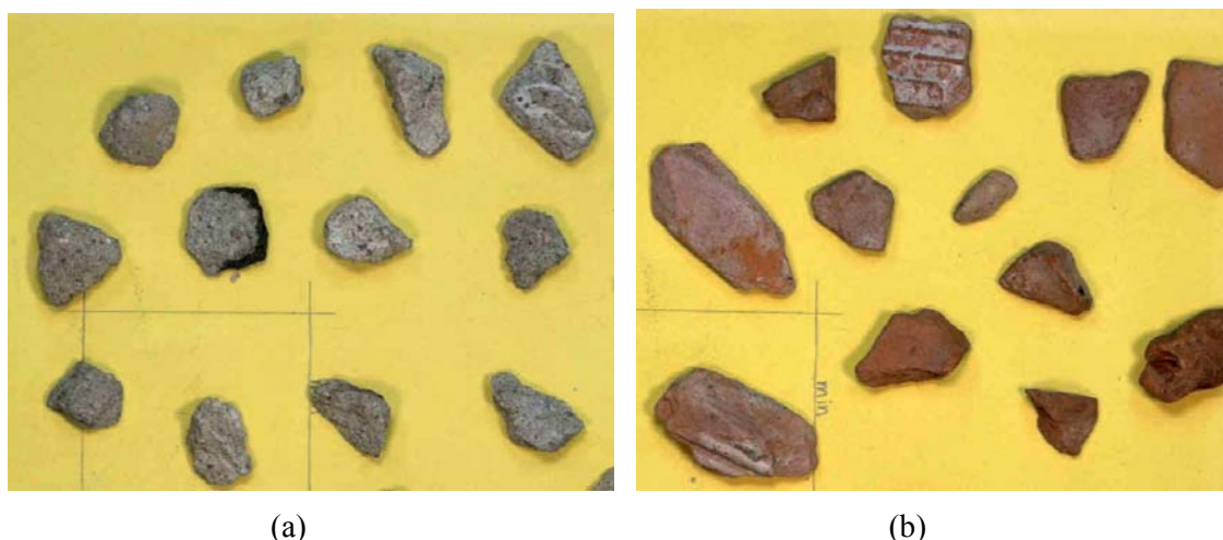
Figura 10 Espécies minerais encontradas no intervalo de separação 1,9 < d < 2,2 \text{ kg/dm}^3 . Partículas cimentícias (a) e partículas de cerâmica vermelha. Observar que as partículas vermelhas encontram-se com a superfície limpa, pouco contaminada com pasta de cimento.
