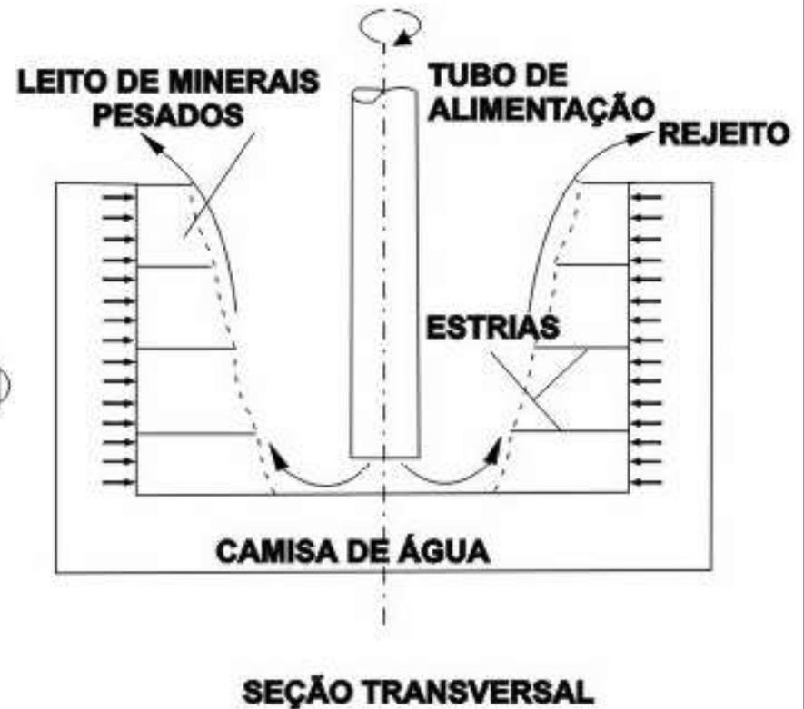
Concentrador centrífugo (a) visão externa, (b) seção transversal.
