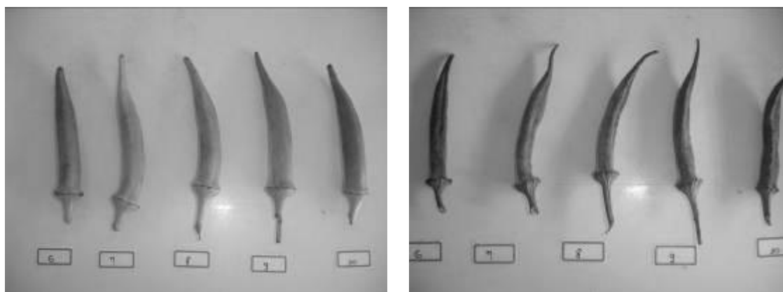
Figura 2 – Quiabos antes e depois do ensaio de desidratação (180°C).
