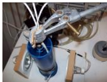
Figura 1: Posicionamento dos termopares. Figura 2: Fixação dos termopares.
