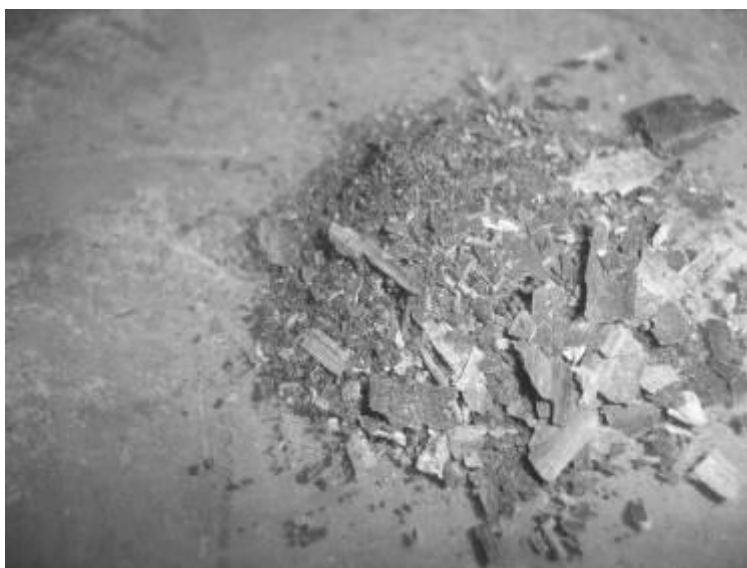
Figura 4 – Quiabos desidratados e triturados para uso como floculante.
