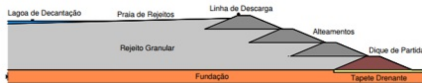
Figura 23. Alteamento de uma barragem de rejeitos pelo método a Montante
