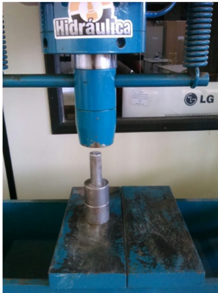
Figura 76. Briquetadeira com a massa de finos de calcário na prensa hidráulica
