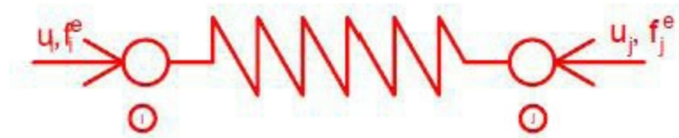
Figura 144. Elemento de mola (e) conectado aos nós i e j
