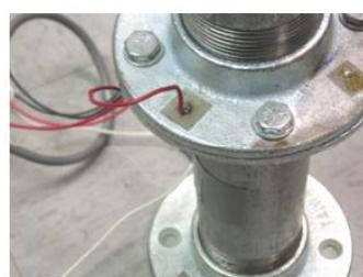
**Figura 1: Pastilha PZT colada na estrutura tubular de teste**
