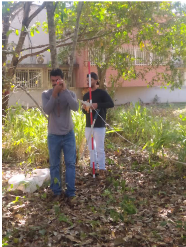
Figura 5. Medição de altura total (Ht) em parcela feita na área de estudo. Fonte: Autores, 2023.
