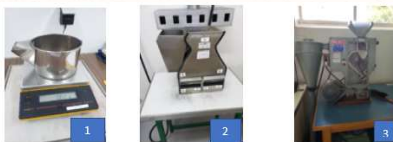
Figura 52. Equipamentos do laboratório de ensaio de sementes – LES. 1 - Balança de precisão; 2 - Homogeneizador de sementes; 3 - Máquina de descascar arroz; SANTOS, 2019.
