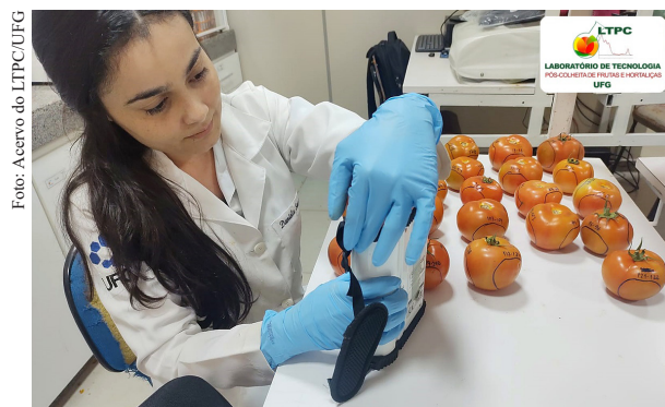
Aplicação de espectroscopia do infravermelho próximo (NIRS) na avaliação não destrutiva de tomates.
