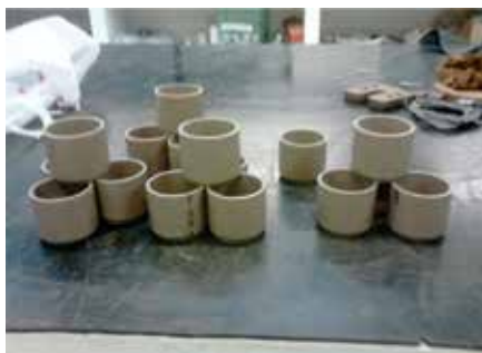
Figura 27. Amostradores para ensaio da metodologia MCT.
