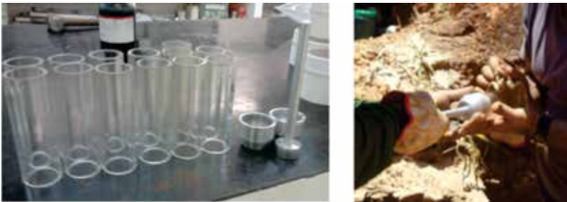
Figura 23. Amostragem de corpos de prova para ensaio Pinhole: a) amostradores de acrílico e acessórios; b) uso em campo.
