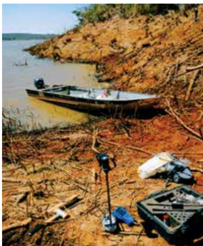
Figura 14. Ensaio geotécnico com penetrômetro Panda às margens do Ribeirão Sarandi (Ponto 1).
