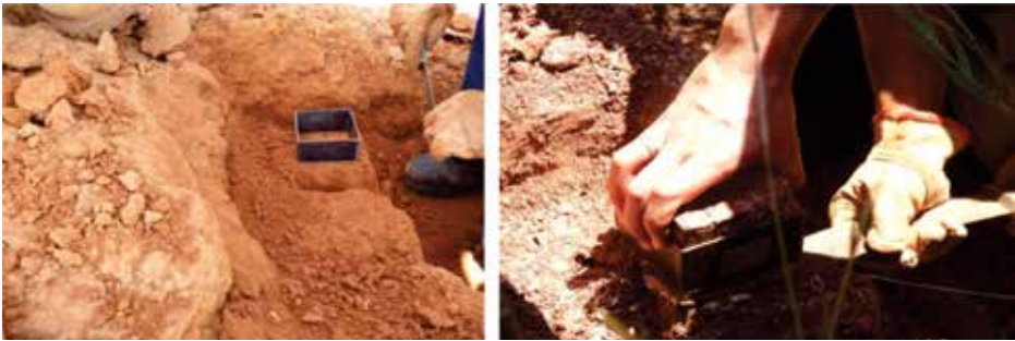
Figura 7. Retirada de amostras indeformadas por meio de moldes metálicos para ensaios de erodibilidade UHE-Furnas(MG). Foto: Maurício M. Sales (2015).
