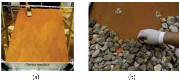
Figura 7. Montagem do talude: a) colocação do solo; b) colocação do RCD-R.
