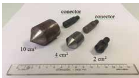
Figura 9. Ponteiros cônicos do equipamento PANDA2 com 10, 4 e 2 cm 2 . Atrás das ponteiros de 10 e 4 cm 2 estão os seus conectores de ligação a haste. Foto: Renato R. Angelim (2016).
