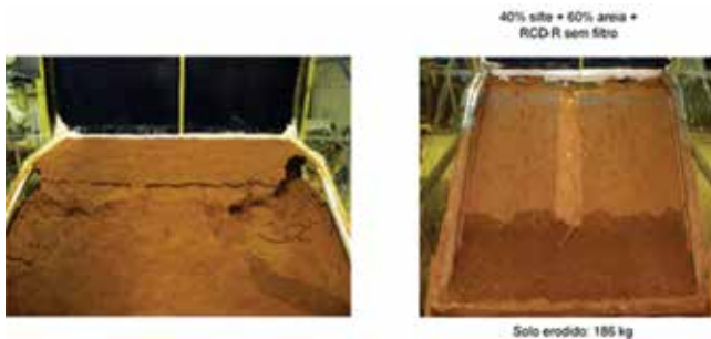
Figura 9. Imagens do talude ao término do ensaio: a) Processo erosivo iniciado na região do impacto das ondas; b) Talude ao término do ensaio.
