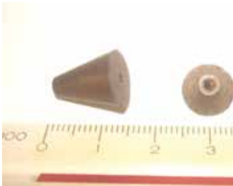
Figura 26. Guia de centralização, com formato cônico e dotado de orifício de 1,5mm de diâmetro.
