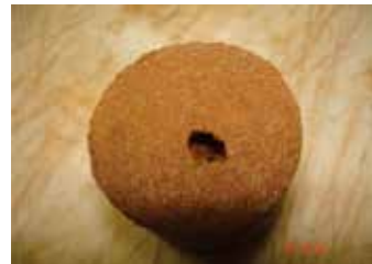
Figura 31. amostra 2.4008.40 Furo de agulha após o ensaio na direção oposta ao sentido do fluxo.
