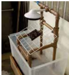
Figura 11. Equipamento de Inderbitzen com gotejamento proposto por Higashi (2006).
