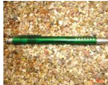
Figura 27. Areia grossa, lavada, passada na peneira de 4,8mm e retida na peneira de 2mm.
