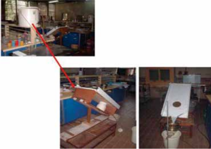
Figura 13. Equipamento de Inderbitzen desenvolvido no Instituto de Geociências da UFRJ por Vilela (2003) apud Stephan (2010).
