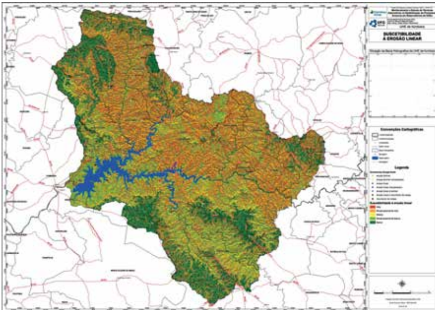
Figura 5. Mapa da suscetibilidade à erosão linear do entorno do reservatório da UHE de Itumbiara.
