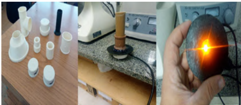
Figura 1. Polarímetro montado com material de baixo custo
