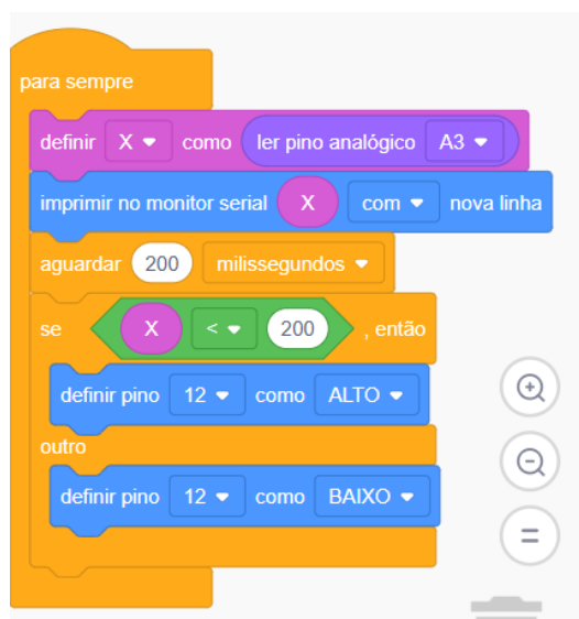
Figura 2. Bloco de programação utilizado para controlar uma saída digital através da leitura de um sensor de umidade do solo.
