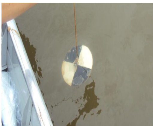
Medindo profundidade com o equipamento disco de Secchi
