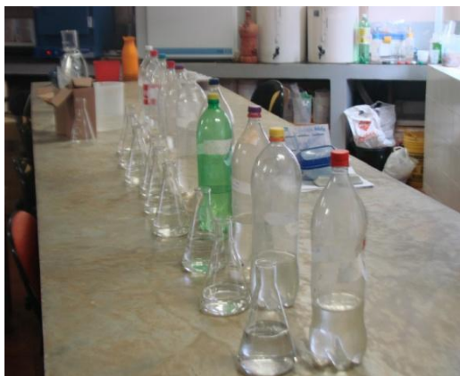
Amostras dos afluentes dos reservatórios preparadas para filtração em bomba a vácuo
