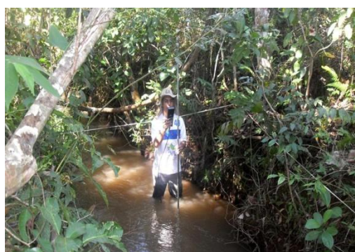
Medindo Vazão com o aparelho Molinete portátil
