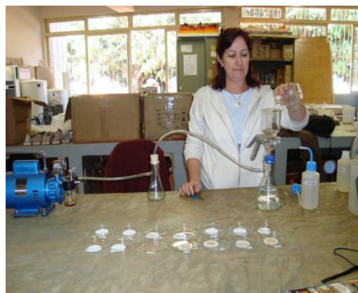
Filtração de amostra de água em bomba a vácuo
