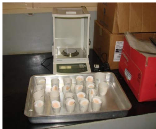
Pesagem da amostra seca em estufa
