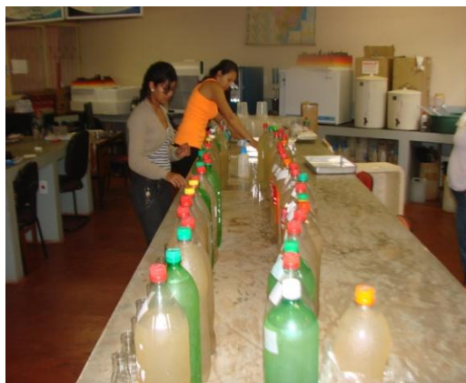
Amostras dos reservatórios preparadas para filtração em bomba a vácuo
