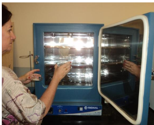
Secagem da amostra filtrada em estufa
