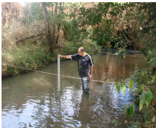
Medindo Vazão com método do flutuador
