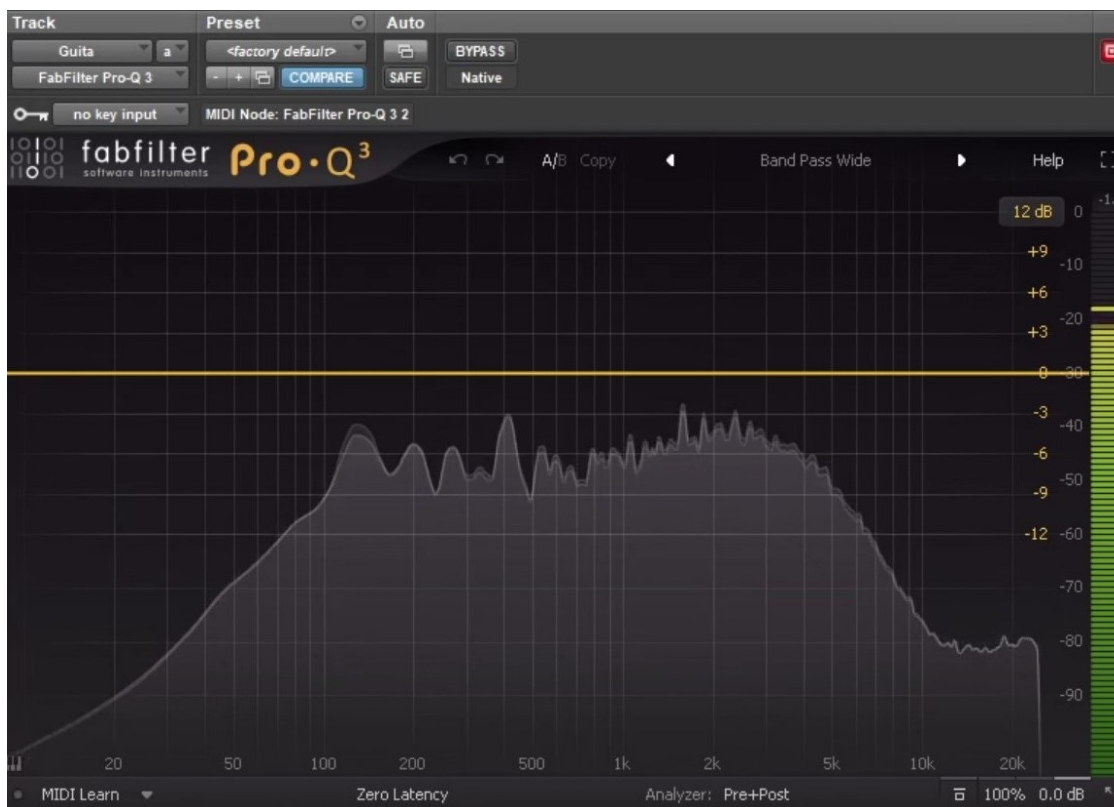
Figura 31 - Espectro de instrumento com pedal de Overdrive somado à Distorção e Simulação de Falante 4x12. Fonte: https://youtu.be/FWSO_-QLftY
