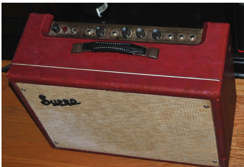
Figura 16 - Amplificador Combo Tremo-Verb Supro, que continha efeito de Reverb e Tremolo Fonte: https://i.pinimg.com/originals/66/ef/5c/66ef5c02b3a76f5725dad596f8b1057a.jpg
