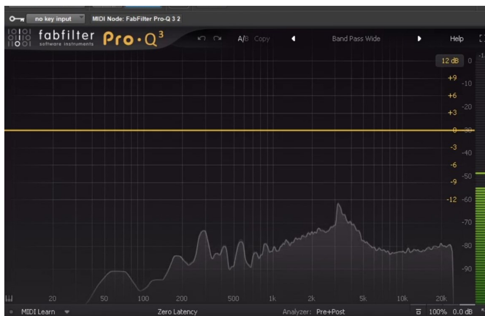
Figura 27 - Espectro de instrumento Distorcido com Chorus e Simulação de Falante 4x12, gerando um ruído de 2 a 5 kHz
