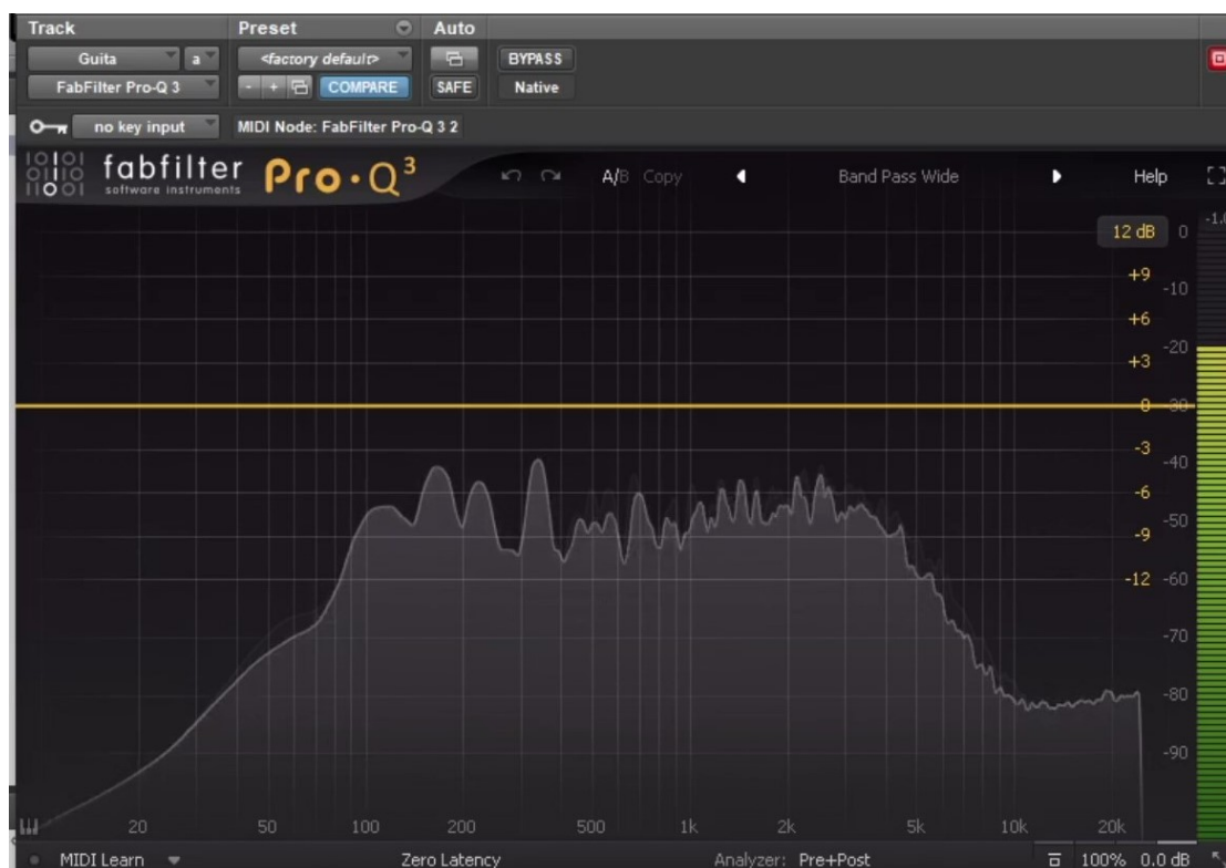
Figura 29 - Espectro de instrumento distorcido com Chorus e com Simulação de Falante 4x12 Fonte: https://youtu.be/FWSO_-QLftY
