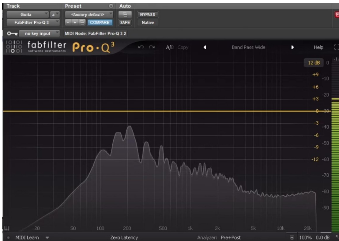
Figura 26 - Espectro de instrumento clean com Chorus e Simulação de Falante 4x12
