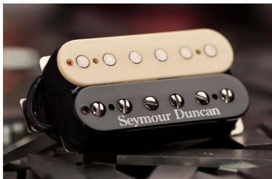
Figura 13 - a. Captador Passivo de Bobina Dupla Seymour Duncan JB - b. Captador Passivo de Bobina Simples Fender Tex Mex
