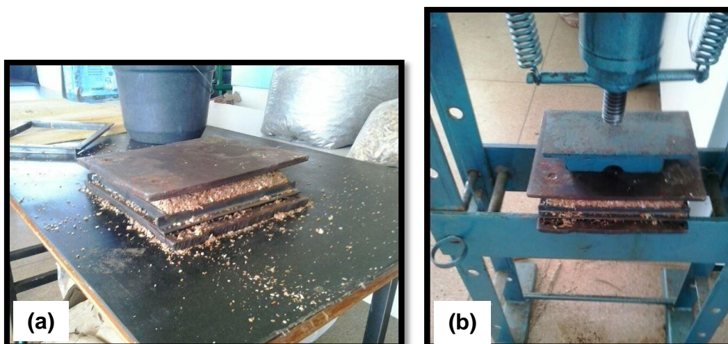
Figura 2. Produção do painel; (a) Formação do colchão; (b) Pré prensagem.
