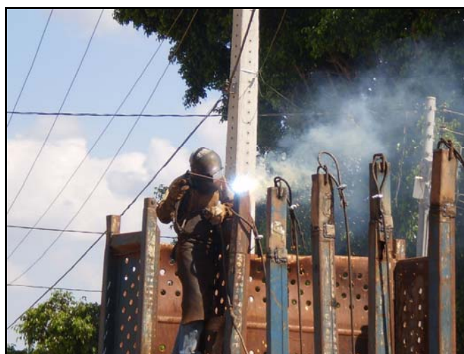
Figura 27: Detalhe da solda a caçamba de transporte de cana. Itapaci, 13 de maio de 2009. Foto: Rangel G. Godinho.
