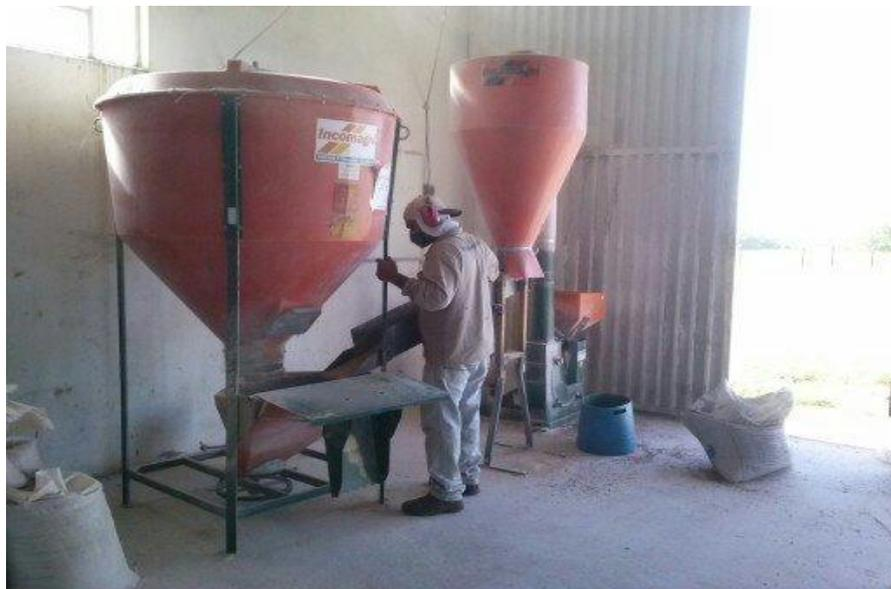
**Figura 10.** Misturador de ração e triturador de grãos.
