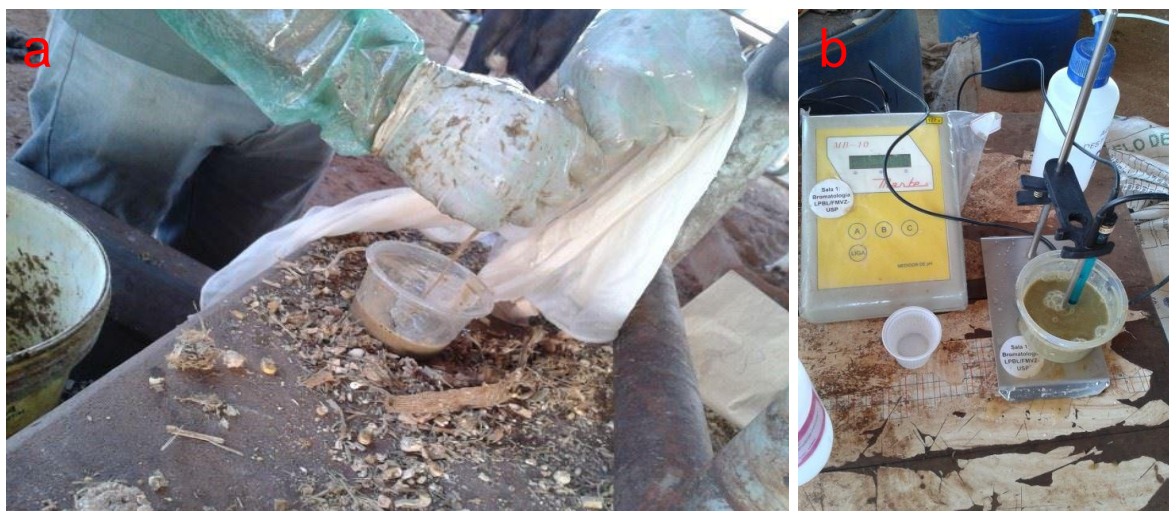
Figura 13. a) Separação das frações sólidas e líquidas e b) leitura de pH.
