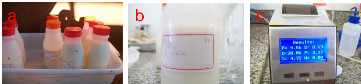
Figura 12. a) Amostras de leite e b) pote identificado e c) aparelho Lactoscan ® .
