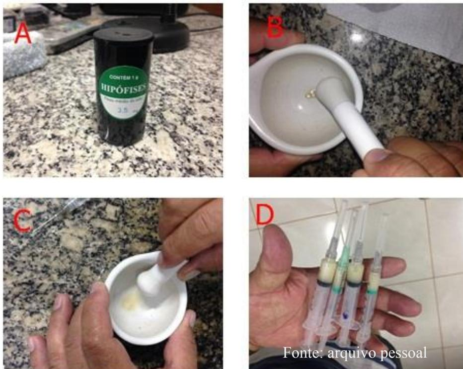
**Figura 9**-Fotografia dos procedimentos de preparação da solução indutora com extrato bruto de hipófise de carpa. **A**= recipiente com peso padronizado de EBHC; **B**=cadinho com EBHC pronta para maceração; **C**=hipófises maceradas e diluídas com solução fisiológica; **D**=seringas com a solução pronta para aplicação.
