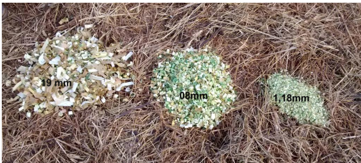
Figura 6. Amostras fracionadas resultantes do uso do jogo de peneiras (Avaliação do tamanho de partículas pelo Método “Penn State”; CARVALHO FILHO, 2016)
