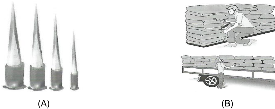
Figura 4. Caladores simples (A) e método de coleta de amostra com caladores simples (B). Fonte: COUTO (2008)
