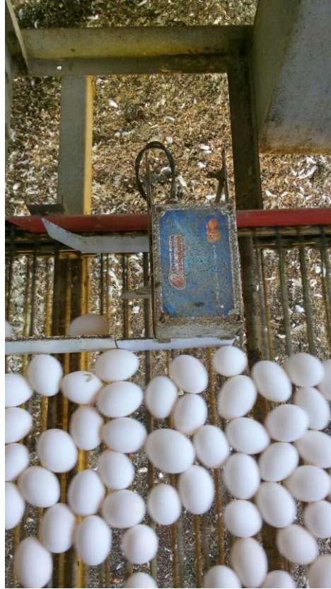
Figura 7. Sensor contador de ovos. Fonte: Arquivo pessoal.
