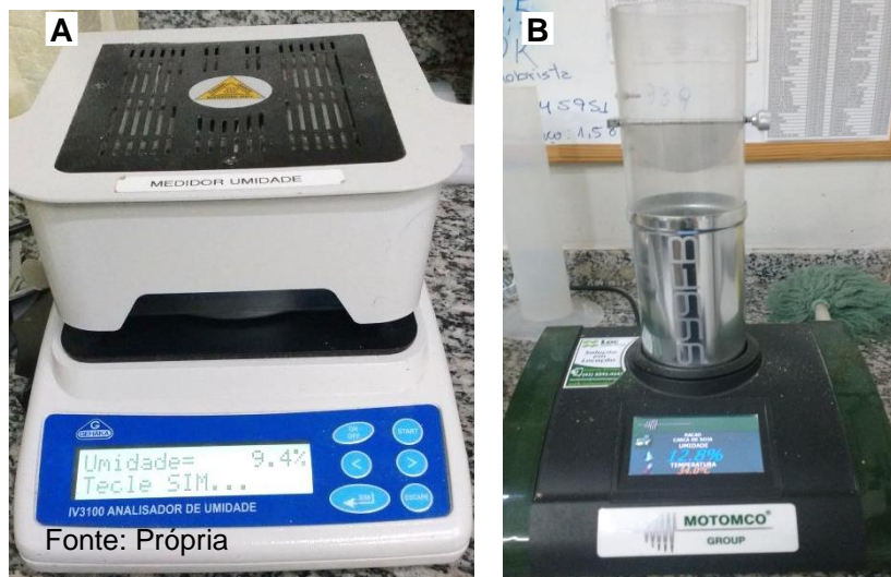
Figura 2. A: método de leitura através de refletância de infravermelho; B: equipamento Motomco.
